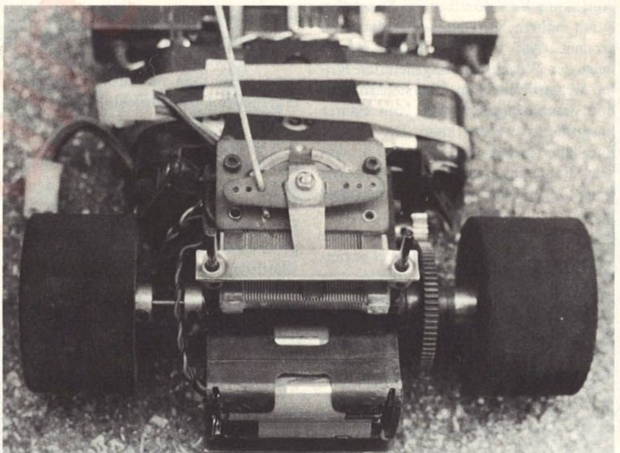
Der Empfänger-Akku findet beim March RX 1200 seinen Platz hinter der Hinterachse.
